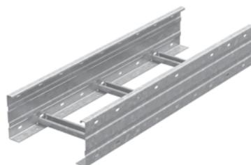
Кабельрост серии ЛКР – это самонесущий лестничный лоток для увеличенных пролетов и повышенных нагрузок кабеля. Повышенная несущая способность кабельростов обеспечивает прокладку трассы на пролетах опор с шагом до 9 м за счет увеличенной толщины металла, специального профиля боковых лаг и дополнительных элементов жесткости дна.
