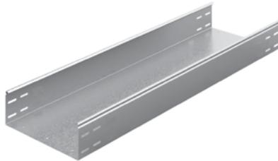
Предназначена для прокладки кабелей любых типов, включая тяжелые кабели большого диаметра. Пригодна для горячего оцинкования и использования в агрессивных средах. Соединение лотков производится с помощью протектора-соединителя, защищающего кабель от повреждения и усиливающего место стыка. Форма замка на бортах лотков скруглена. Выпускается в перфорированном и неперфорированном вариантах. Может комплектоваться крышкой.
